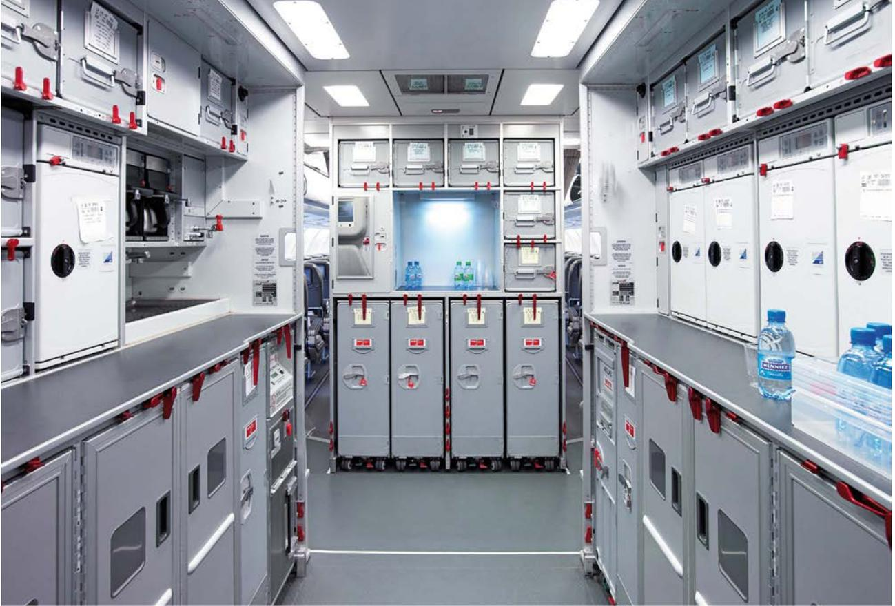
Bordküchen aus Aluminium erfüllen die Ansprüche an Leichtigkeit, Ästhetik und Flexibilität (Swiss A330 Bordküche). © Bucher Leichtbau AG
