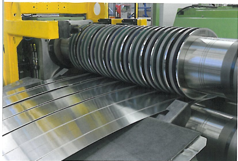
Aluminiumbänder über ein besonderes Verfahren gespalten – ohne Schnittkante Slitting of aluminium strips by a special method – without cut edges
