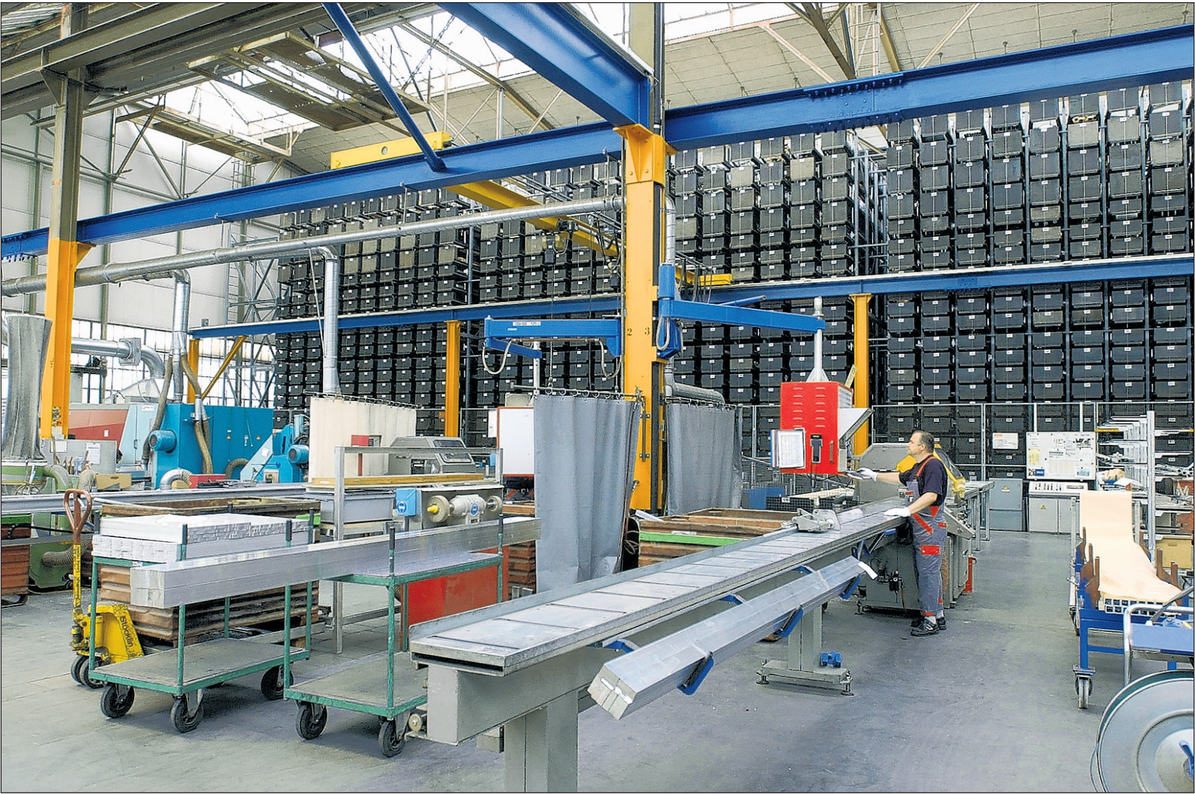
Prozesseffizienz: Vollautomatisches Hochregallager mit 2250 Kassetten und angegliederten Sägen zur Bearbeitung von Profilen, Stangen und Rohren.
