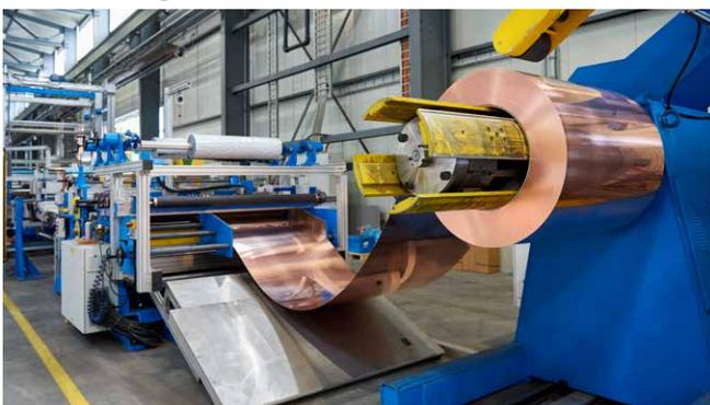
Les grosses bobines d'au plus 12 t et de largeur maximale 1600 mm peuvent être rembobinées dans des formats plus petits et spécifiques au client.
