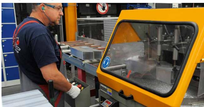
Pour les coupes transversales de 3 à 100 mm, il est possible de réaliser des coupes à l'onglet.
