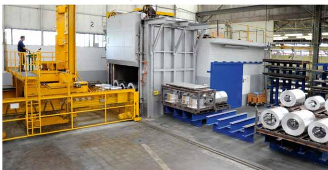
Traitement au four pour obtenir des degrés de dureté intermédiaires ou l'adoucissement.
