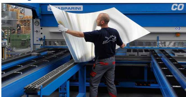
Trois cisaillies réalisent les découpes à dimensions fixes selon les spécifications du client, de forme rectangulaire, triangulaire ou carrée, dans des tolérances serrées.
