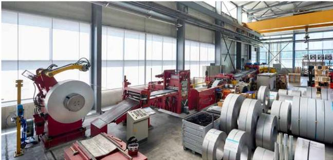
Les bobines peuvent être découpées transversalement en tôles de dimensions fixes, dans des tolérances très serrées.
