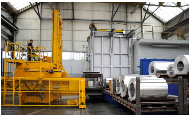
Elektro-Ofen für das Weichglühen von Walzprodukten aus Aluminium.
