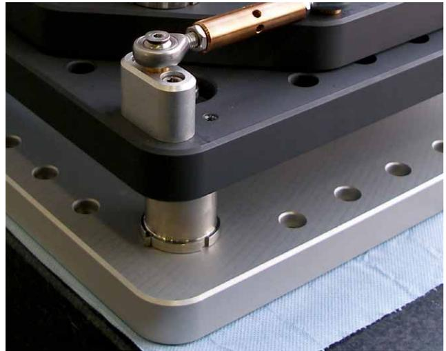
Farbig anodisierte Aluminium-Gussplatte:
