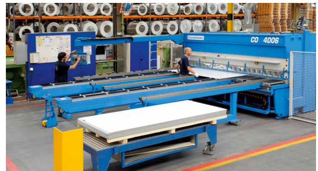
Tafelschere: Blechzuschnitte mit engen Toleranzen
