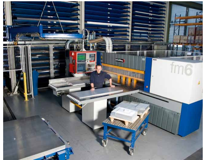
Vom Hochregal-Lager direkt an die drei Plattensägen
