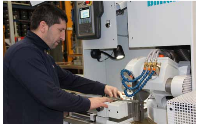
...und mit der Feintrennsäge auch für kleinere Teile.
