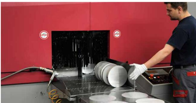
Auf verschiedenen Kreis- und Bandsägen werden Fixlängen mit engsten Toleranzen gefertigt. Max. Durchmesser 400 mm
