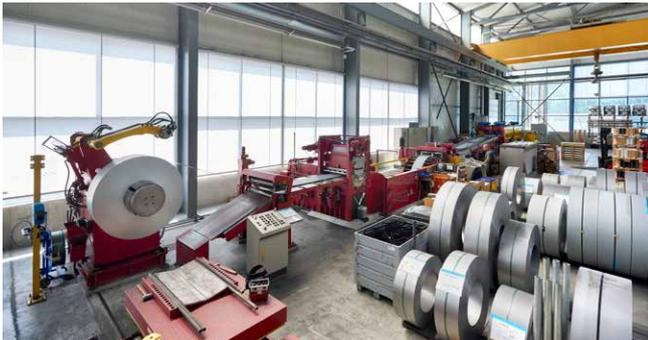
Ab Coils werden Fixmass-Bleche in engsten Toleranzen quergeteilt.
