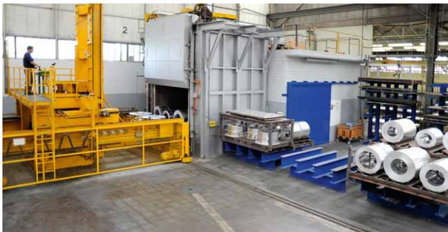
Im Ofen werden die Plattenzuschnitte spannungsarm weichgeglüht (Tensless).
