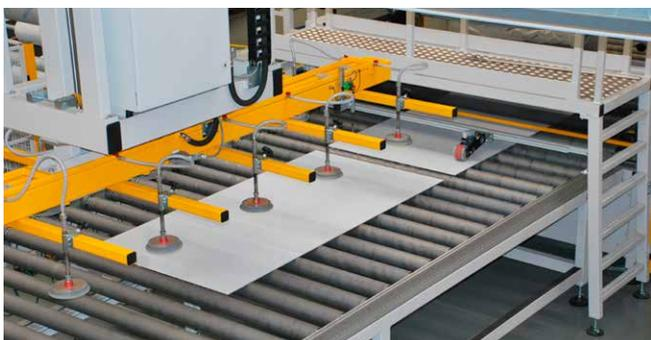
Die Platten werden ein- oder beidseitig mit einer Arbeitsschutzfolie versehen. Je nach Anwendung stehen unterschiedliche Folientypen zur Verfügung.
