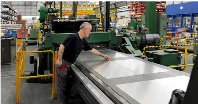
Querteilen ab Band: Die Bleche werden auf Fixlänge nach Kundenwunsch ab Band abgelängt.
