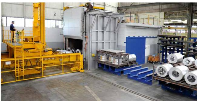
Im Ofen werden die Profile, Stangen und Rohre weichgeglüht.
