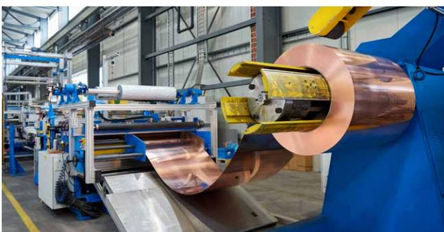
Grosse Coils von maximal 12 Tonnen und maximal 1600 mm Breite werden auf kleinere, kundenspezifische Coils umgerollt.
